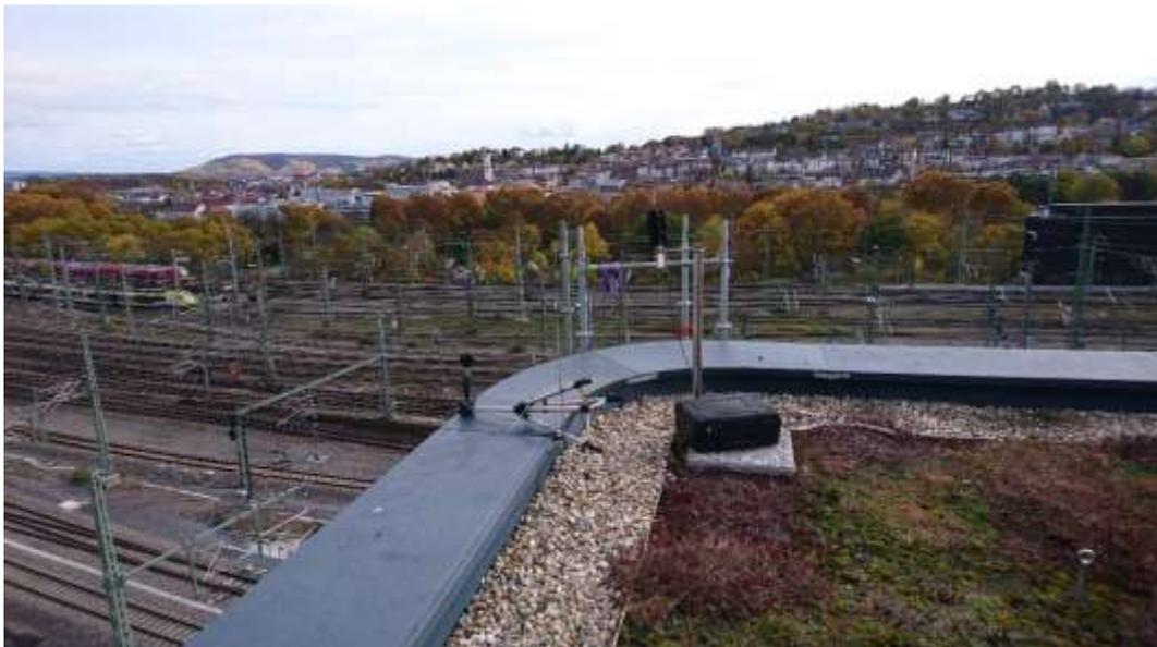
Der S-Bahn-Tunnel verläuft zwischen der auf dem Foto zu erkennenden Bahnanlage und dem Gebäude „Osloer Straße 15-17“. Daher werden von der Dauermessanlage prinzipbedingt neben den Geräuschemissionen der Baumaßnahmen am S-Bahn-Tunnel und nördlich vom Gebäude gelegenen Baustelleneinrichtungsfläche auch die Geräuschemissionen aus dem Schienenverkehr aus den Gleisanlagen registriert.
