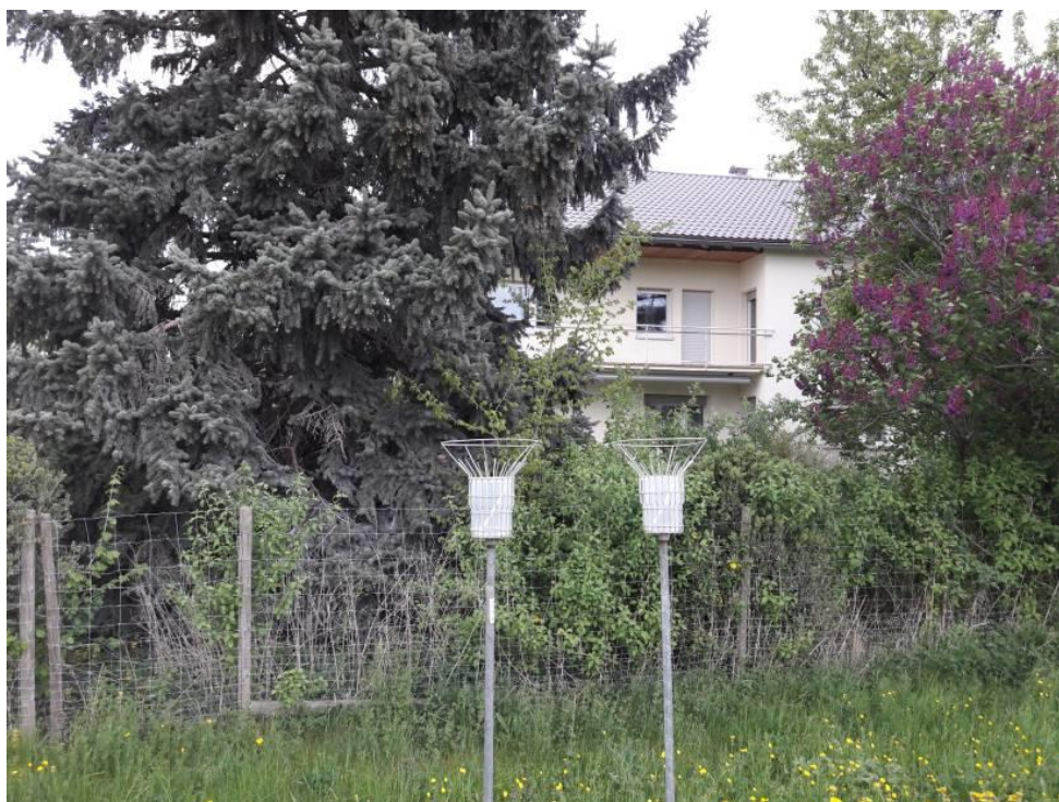
Abb. 1: Topfsammler mit aufgesetztem Vogelschutz für den Staubniederschlag an Messpunkt MP 3. Hier mit 2 Gefäßen zur Qualitätssteigerung. Foto: DEKRA.
